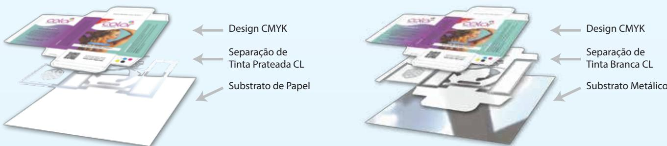
Os dois diagramas acima mostram como o Process Metallic Color System funciona em substratos brancos com tinta prateada (à esquerda) e em substratos metálicos com tinta branca (à direita).
